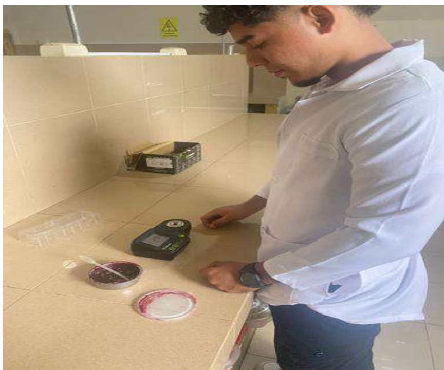
Imagen 12. Medición de ° Brix con instrumento refractómetro
